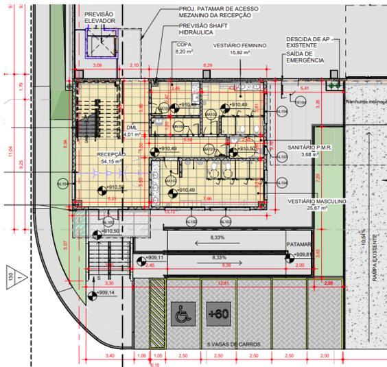
Planta piso térreo e elevação frontal da nova recepção do módulo 14.
